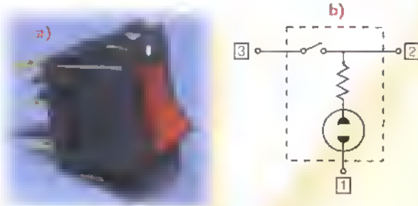
Figura 7.25. Aspecto físico (a) y circuito interno (b) de un interruptor con piloto de neón incorporado
